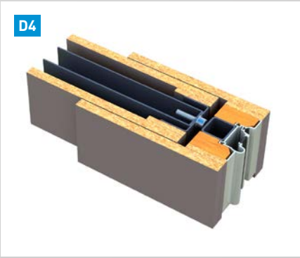
D4 Ukončení teleskopického panelu u stěny LIKOSPACE 120
