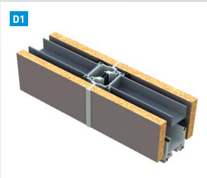
D1 Svislé napojení panelů s viditelným AL profilem u stěny LIKOSPACE 100
