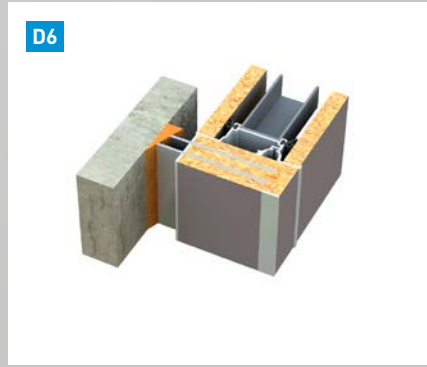
D6 Napojení mobilní stěny k rovnoběžné stěně
